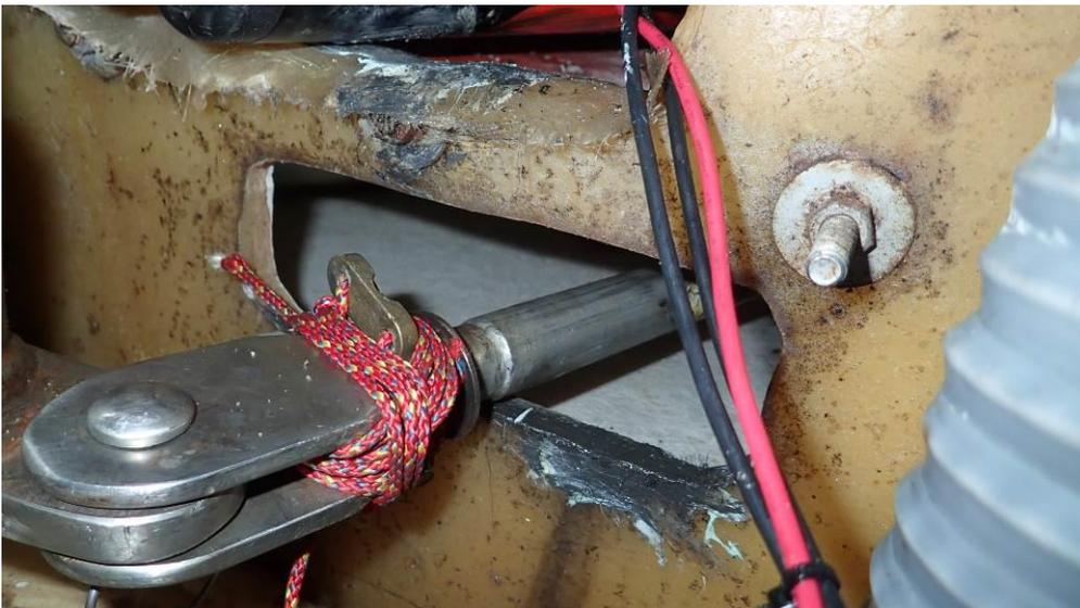
demontiere, mich am Kopf kratze und überlege was für Mittel mir zur Reparatur zur Verfügung stehen – viel ist es nicht und Schweißen kann ich schon gar nicht. Mit einem Dynema Tampen, einer Batterieklemme sowie einer Schlauchschelle gelingt es nach zwei Stunden die Bruchstelle zu überbrücken, ein Hurra auf das Dynema! Der Autopilot läuft wieder das Schiff bleibt brav auf
